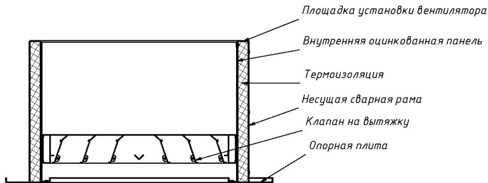
Стаканы серии **СТП-Ш** (шумоглушащий) отличаются от **СТП** наличием на внутренних боковых стенках звукопоглощающего материала. На стаканах **СТП-Ш 1065** и выше имеются дополнительные кассеты со звукопоглощающим материалом. Ниже в таблице приведены величины ослабления шума в стакане типа **СТП-Ш**:
